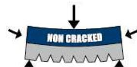
Cargas para un anclaje simple sin efecto de distancia al borde o de espaciamiento con  $h \geq 2h_{ef}$
